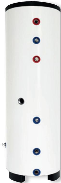
Der Wärmepumpen-Brauchwasserspeicher hat ein Volumen von 300 Litern und ist im Kern aus hochwertigem Edelstahl [Duplex 2205] gefertigt. Der Aussenmantel besteht aus galvanisiertem und lackiertem Stahl. Dank der 50 mm PU-Hartschaumisolierung erreicht der Speicher die Effizienzklasse A nach EN 12977-3:2012.
