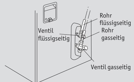
3. Ziehen Sie die Überwurfmutter zuerst von Hand an.
