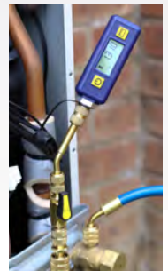
5° gebogene ¼-Börsenbuchse zum direkten Anschluss an das System für eine genauere Ablesung
