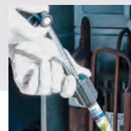
Injektion du colorant en tournant la poignée.
