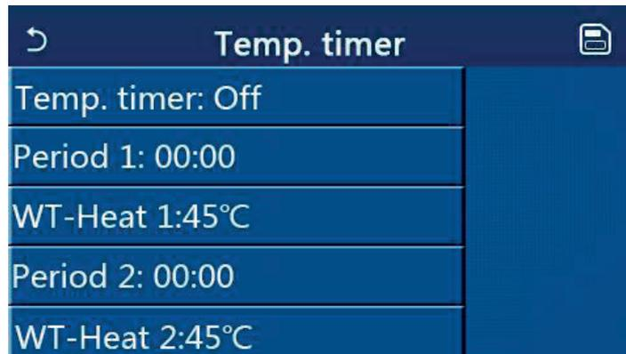
Wählen Sie „Periode 1“/„Periode 2“ und ein Fenster öffnet sich, in dem der Zeitraum eingestellt werden kann. Wählen Sie dann „WT-Heat1/WT-Cool 1/2“ und es öffnet sich auch ein Fenster, in dem die Temperatur eingestellt werden kann.
