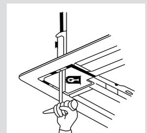
Wenn nach der Installation immer noch eine Lücke zwischen Decke und Abdeckung besteht, justieren Sie das gesamte Gerät, bis es passgenau mit der Decke abschließt.
