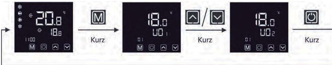
Um die Betriebsparameter anzuzeigen drücken Sie im Startbildschirm kurz die **M**-Taste. Hier können nun Sensorwerte und andere Betriebszustände abgefragt werden. Die Navigation zwischen den verschiedenen Betriebsparametern erfolgt mithilfe der **↑**-Taste und der **↓**-Taste.
