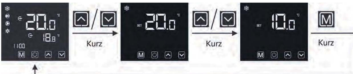
Um den Sollwert für die Rücklauftemperatur einzustellen, drücken Sie im Startbildschirm die - Taste oder die - Taste kurz. Die Anzeige blinkt. Nun lässt sich mit den selben Tasten der Sollwert in 0,5 Schritten verändern. Ist die gewünschte Temperatur eingestellt, bestätigen Sie die Eingabe mit der - Taste.
