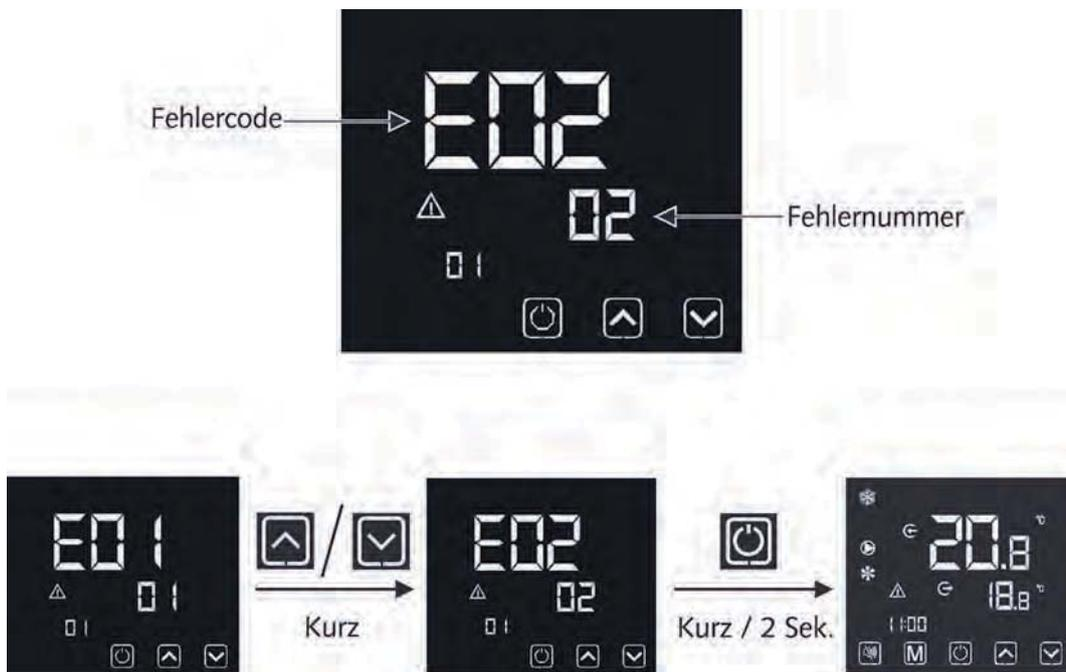
Wenn ein Fehler am Gerät auftritt, meldet dies der Regler automatisch. Der Bildschirm geht in die Fehleransicht über und zeigt einen Fehlercode. Die Bedeutungen der verschiedenen Codes sind unter dem Kapitel *Fehler und Fehlerursachen* gelistet.
