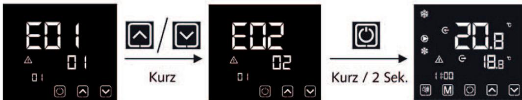
Wenn ein Fehler am Gerät auftritt, meldet dies der Regler automatisch. Der Bildschirm geht in die Fehleransicht über und zeigt einen Fehlercode. Die Bedeutungen der verschiedenen Codes sind unter dem Kapitel Fehler und Fehlerursachen gelistet.
