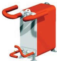
**Verdampfer:** Der Verdampfer ist vor Eis infolge niedriger Verdampfungstemperaturen durch die Frostschutzfunktion der elektronischen Steuerung geschützt, die die Wasseraustrittstemperatur regelt. Weiterhin verfügt jeder Verdampfer über einen Differentialdruckschalter, der ihn vor Wassermangel schützt. Die Ummantelung ist außen mit einer aluinierten Antikondens-Isolierschicht mit einer Stärke von 9 mm beschichtet.
