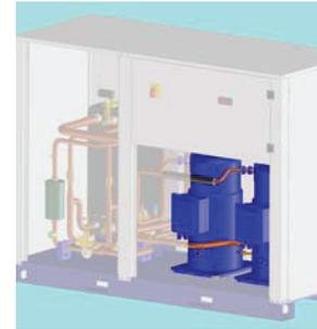
Der 2-polige E-Motor wird durch das vom Kompressor (nur Scroll-Kompressor) angesaugte Gas gekühlt und ist durch ein internes Temperaturregelmodul vor Übertemperaturen in den Wicklungen geschützt. Weiter sind die Kompressoren durch Schalter, Sicherungen oder magnetothermische Schalter geschützt. Alle Kompressoren sind auf Gummischwingungsdämpfer montiert.
