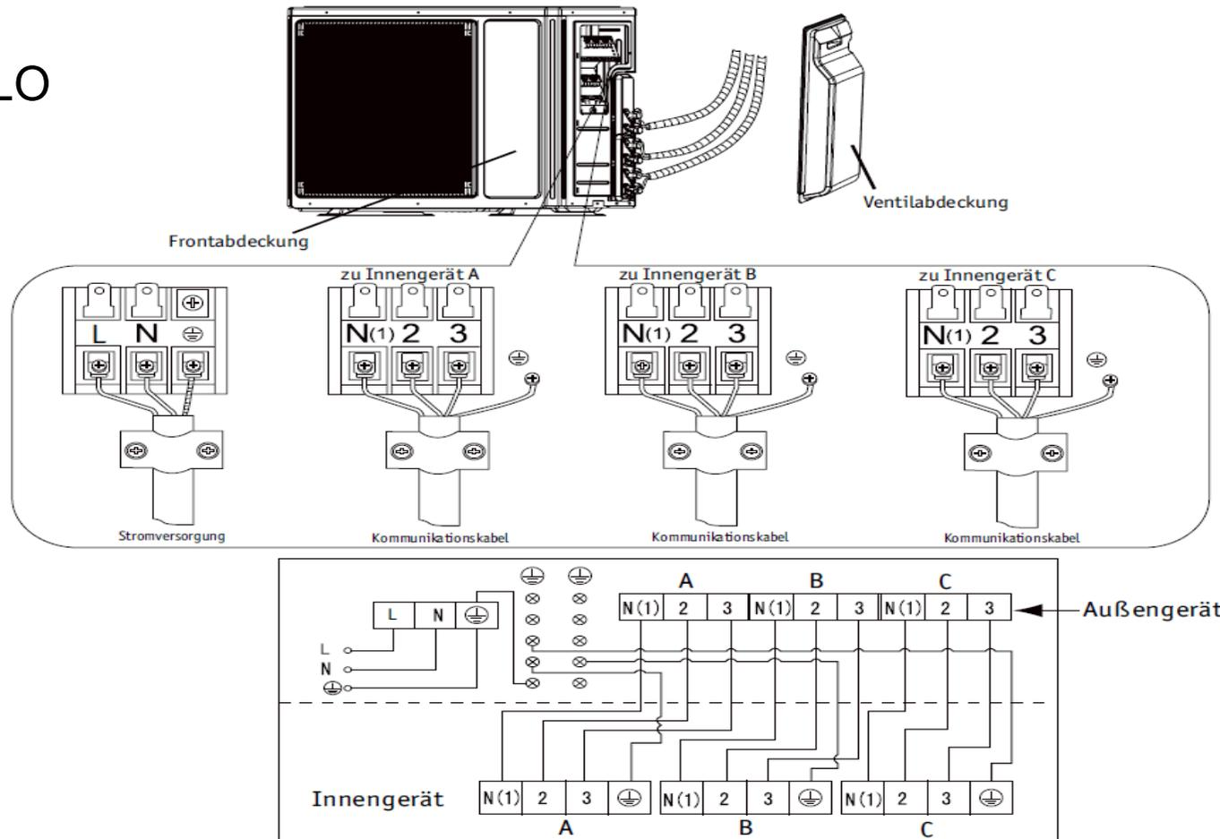
**Spannungsversorgung = 230 Volt / 1 Ph / 50 Hz**
