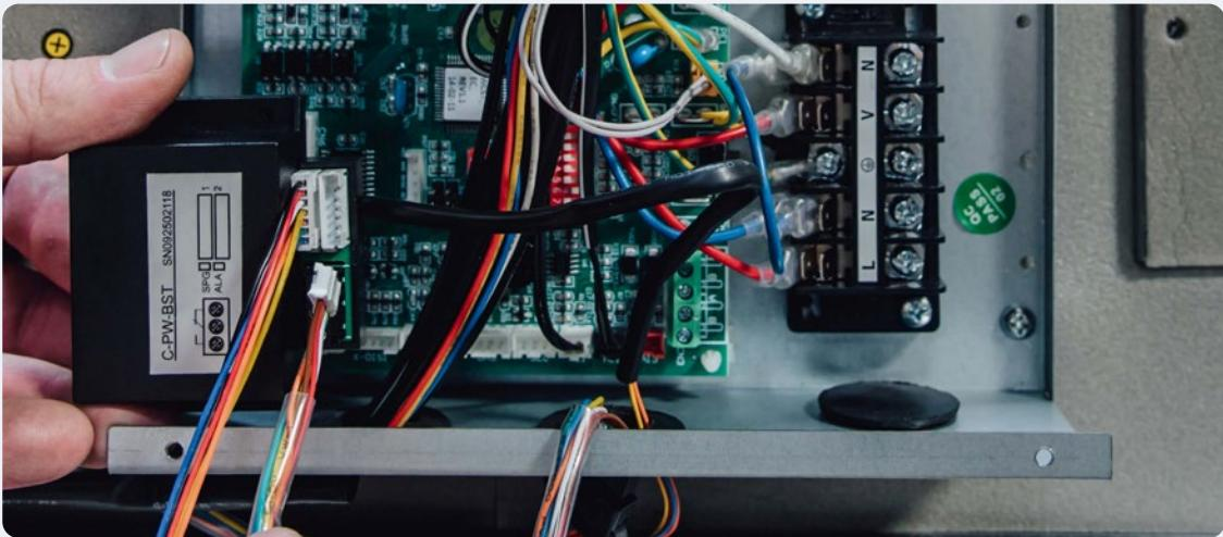
2. Stecken Sie das zuvor abgezogene Verbindungskabel auf den freien Steckplatz an dem Störmeldemodul auf.
