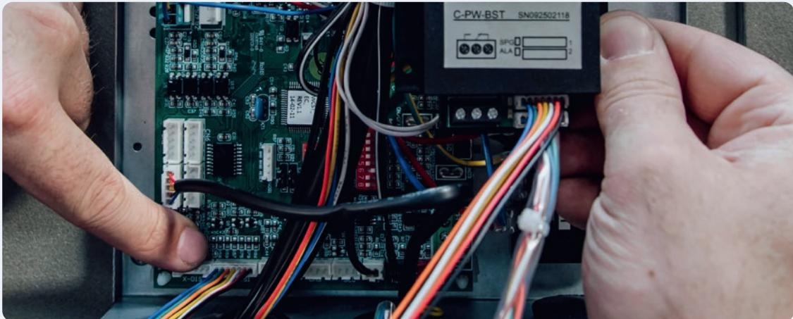
3. Verbinden Sie das Störmeldemodul, indem Sie dessen Kabel auf den Steckplatz X-DIS1 stecken.
