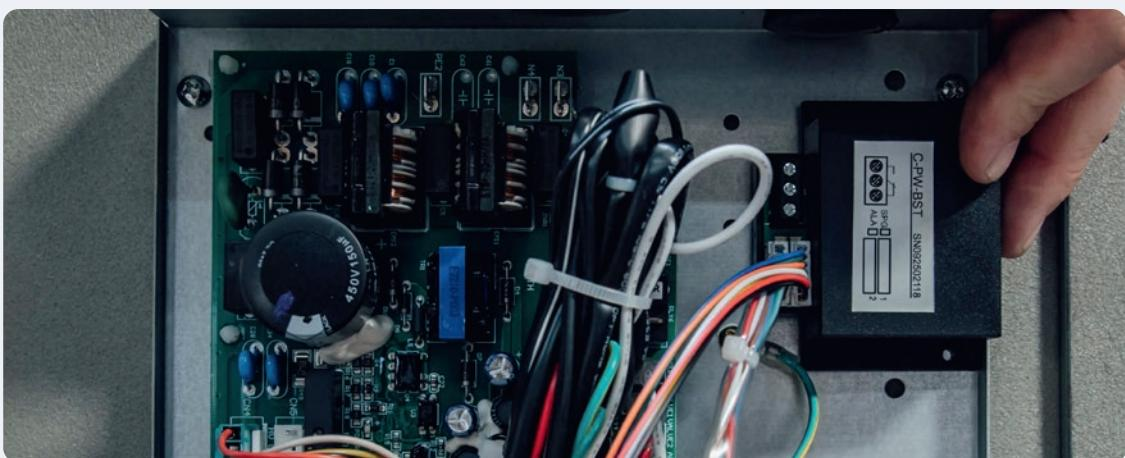
4. Modul oben rechts im Anschlusskasten montieren, Störmeldung über Wechslerkontakt anschließen.
