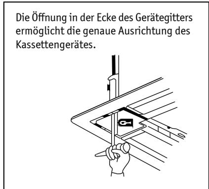
Wenn nach der Installation immer noch eine Lücke zwischen Decke und Abdeckung besteht, justieren Sie das gesamte Gerät, bis das Gitter passgenau mit der Decke abschließt.
