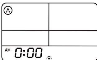
Nach Betätigung der tiefer liegenden Taste C mittels eines kleinen Stiftes o. ä., blinkt die Anzeige der Uhrzeit. Durch Halten der Taste TIME-SET wird anfänglich langsam und dann immer schneller die angezeigte Uhrzeit verstellt. Nach erfolgter Einstellung wird die Taste C erneut gedrückt um die Uhrzeit zu speichern. Die Anzeige blinkt nicht mehr.
