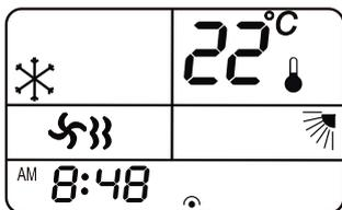
Die Taste TEMP ermöglicht die Einstellung der gewünschten Solltemperatur in 1 °C Schritten. Im Umluftmodus FAN ist diese Einstellung nicht möglich.
