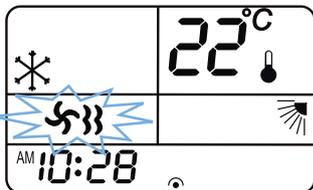
Durch Betätigung der Taste „TURBO“ wird die Ventilator-drehzahl besonders hoch eingestellt und das Ventilatorsymbol der Stufe H beginnt zu blinken. Diese Stufe wird verwendet, um z.B. den Raum schneller abzu-kühlen oder zu erwärmen.
