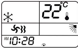
Nach Betätigung der Taste „FAN“ wird in der Anzeige die Ventilatorgeschwindigkeit „AUTO“ sichtbar. Jede weitere Betätigung der Taste führt zu einer hohen (H), mittleren (M) und niedrigen (L) Einstellung der Geschwindigkeit.
