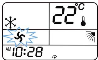
Durch Betätigung der Taste „SILENT“ wird die Ventilator-drehzahl besonders niedrig eingestellt und das Ventilatorsymbol beginnt zu blinken. Diese Stufe wird verwendet, um z.B. die Schallemission nochmals zu reduzieren.
